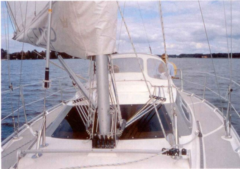
Ein weiterer Beitrag der Werft zur Sicherheit auf See: Alle Fallen und Reffleinen werden ins Cockpit geführt
